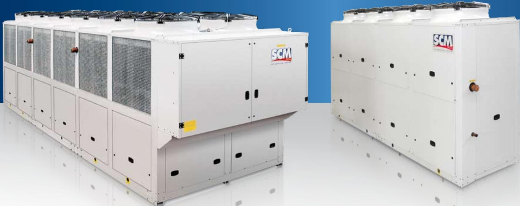
**IT** Centrali frigorifere multiservizio con compressori accoppiati in parallelo con **sistema di equilibratura dell'olio AC&R** (solo con i compressori scroll la parallelizzazione è diretta). La serie UMC è realizzata per l'installazione all'esterno con **condensazione ad aria**. Le centrali frigorifere UMC sono complete di quadro elettrico con microprocessore e sonde di pressione. La serie UMC è prevista con compressori ermetici, semiermetici alternativi e semiermetici a vite.
